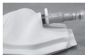
Foto 5 Schieben Sie den Schlauch so lange, bis er auf die Anhebung am Verbindungsstück stößt.
